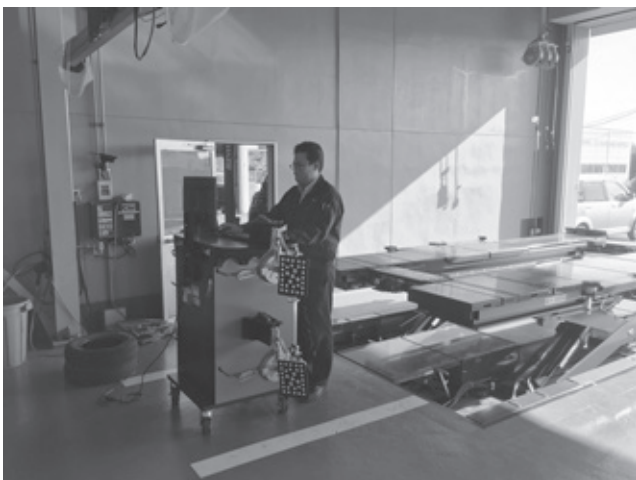
エイミング作業を行うため、アライメント調整機を導入
