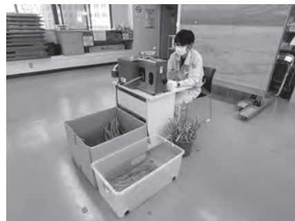
機器使用による廃棄電線の分離作業の様子
