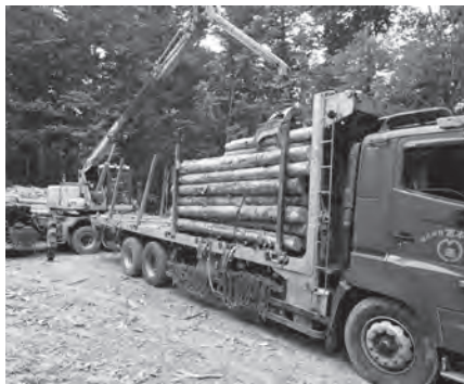
運搬用車両への積み込み
